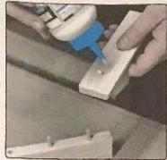
Alle Teile kontrollieren, Leim, vier Schraubzwingen und zwei Zulagen (min. 25 cm lang) bereitlegen und einen Partner zu Hilfe holen. Etwas Leim in die Dübellöcher und auf die Stirnseiten geben.
